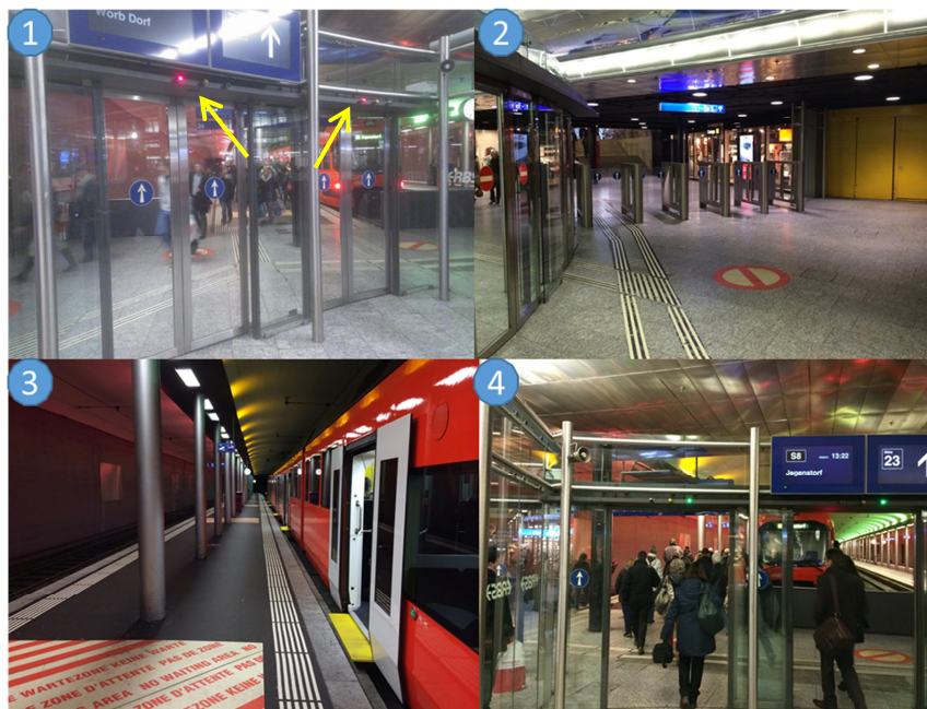
Abb. 6-15: Situation am Bahnhof RBS Bern. Die Bilder zeigen exemplarisch, wie durch gezielte Kundenlenkung und Bodenmarkierungen auf engem Raum ein reibungsloser Betrieb abgewickelt wird.
