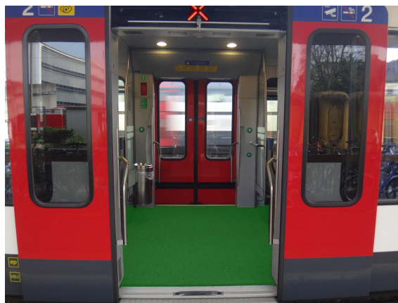
Abb. 7-15: Fehlende Türtaster und ein rotes Verbotskreuz über den Türflügeln kennzeichnen eine reine Ausstiegstüre (Fotomontage).
