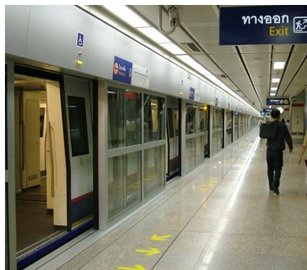
Abb. 6-3: Ausrüstung der Bahnsteige mit automatischen Türschleusen zum Zug [19].
