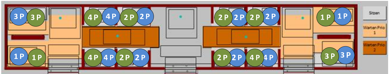
Abb. 12-85: Verteilung der Fahrgäste in der angepassten ISBv3 vor und nach erfolgtem Fahrgastwechsel. F=60 Ein-/ Aussteiger. Die lichte Weite, welche zum Ein-/ Aussteigen zur Verfügung steht, beträgt 4.20 m.
