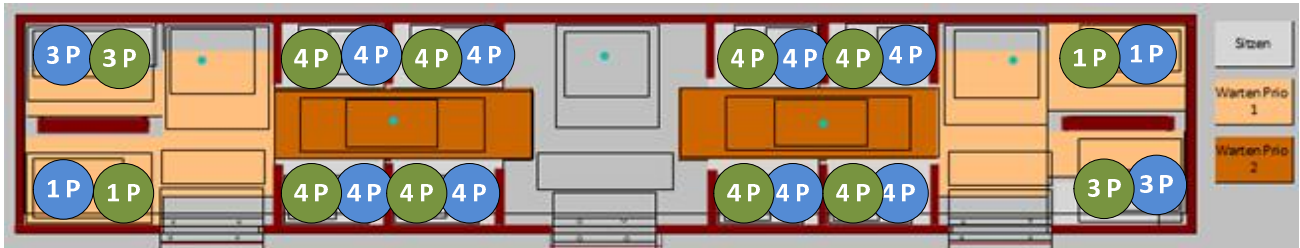
Abb. 12-83: Verteilung der Fahrgäste in der angepassten ISBv3 und nach erfolgtem Fahrgastwechsel. F=80 Ein-/ Aussteiger. Die lichte Weite, welche zum Ein-/ Aussteigen zur Verfügung steht, beträgt 4.20 m.
