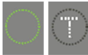
Abb. 6-12: Lichtsignale «Zp 9» und «Zp 10» zur fahrdienstlichen Abfertigung des Zuges [27].
