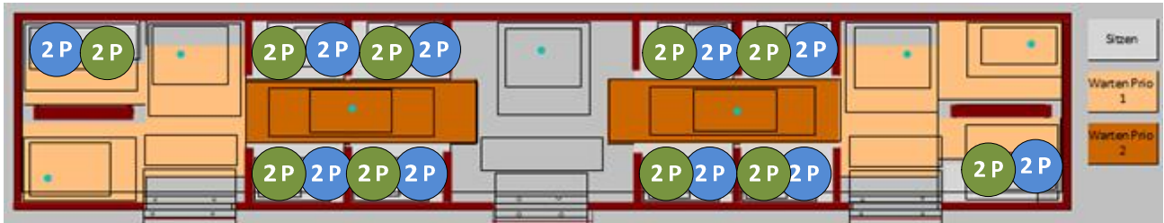
Abb. 12-87: Verteilung der Fahrgäste in der angepassten ISBv3 vor und nach erfolgtem Fahrgastwechsel. F=40 Ein-/ Aussteiger. Die lichte Weite, welche zum Ein-/ Aussteigen zur Verfügung steht, beträgt 4.20 m.
