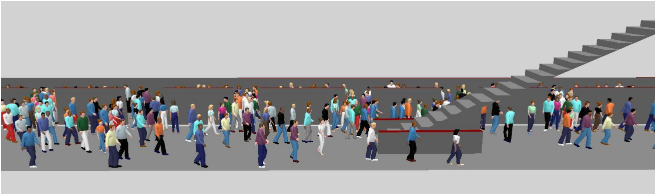
Abb. 8-29: 3D-Simulationsaufnahme am Bahnhof Hardbrücke mit dem Layout der ISB, Vierfachtraktion, getrenntes Ein-/ Ausstiegskonzept. Zu sehen ist die Treppe 5, welche zur Hardbrücke hinauf führt.
