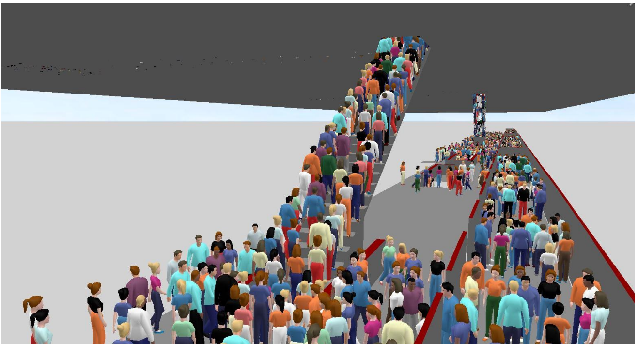
Abb. 8-30: 3D-Simulationsaufnahme am Bahnhof Hardbrücke mit dem Layout der ISB, Vierfachtraktion, getrenntes Ein-/ Ausstiegskonzept. Zu sehen sind die Treppen 2 bis 5 sowie drei der vier ISB-Einheiten.
