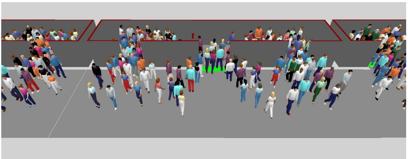
Abb. 8-26: 3D-Simulationsaufnahme der Vergleichssimulation ISB/ ISBv3 Zug. Zu sehen sind drei Wagen der ISB mit getrenntem Ein- und Ausstiegskonzept.
